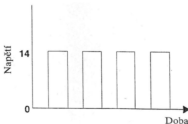
Obrázek 13- typický signál ze snímače rychlosti vozidla
