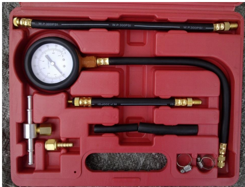
Obrázek 37- měřidlo tlaku paliva
