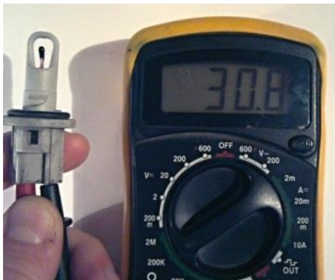
Obrázek 6- měření el. odporu snímače teploty nasávaného vzduchu pomocí multimetru
