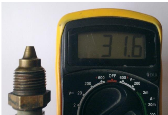
Obrázek 5- měření el. odporu snímače teploty chladicí kapaliny pomocí multimetru
