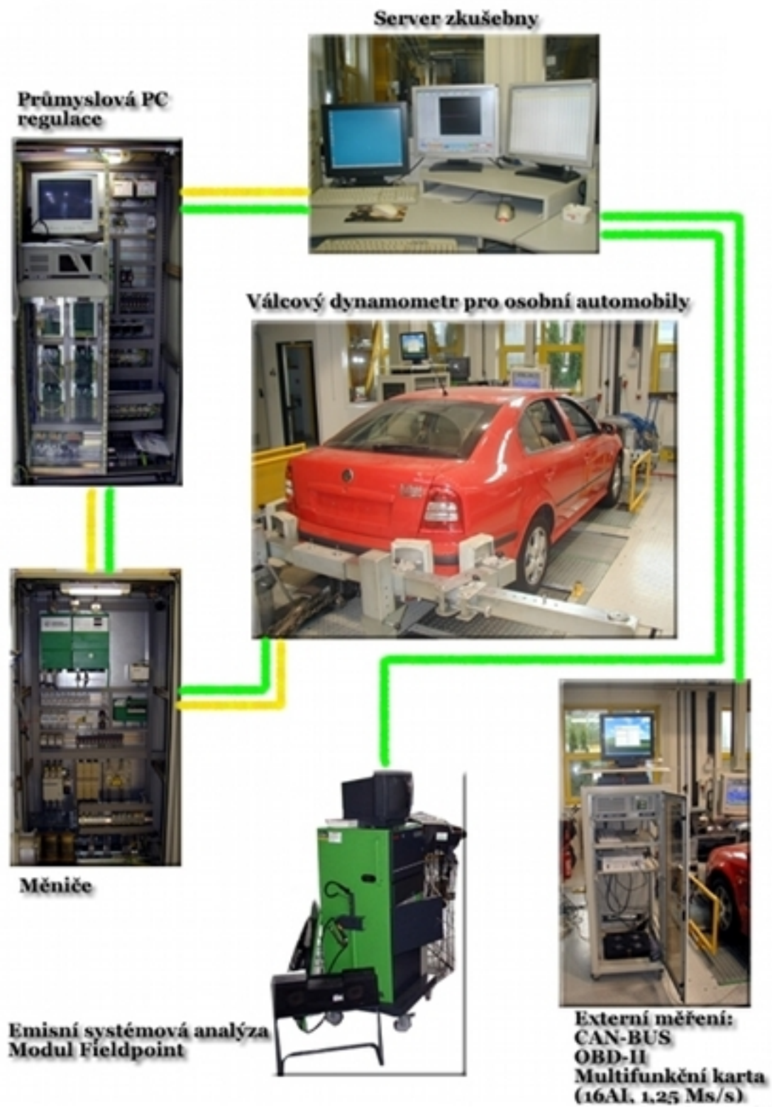
Obrázek 18: Decentralizovaný systém měření válcového dynamometru na MZLU v Brně
